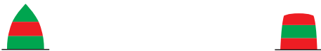
Steuerbordseite des durchgehenden Fahrwassers und Backbordseite des abzweigenden oder einmündenden Fahrwassers Backbordseite des durchgehenden Fahrwassers und Steuerbordseite des abzweigenden oder einmündenden Fahrwassers
